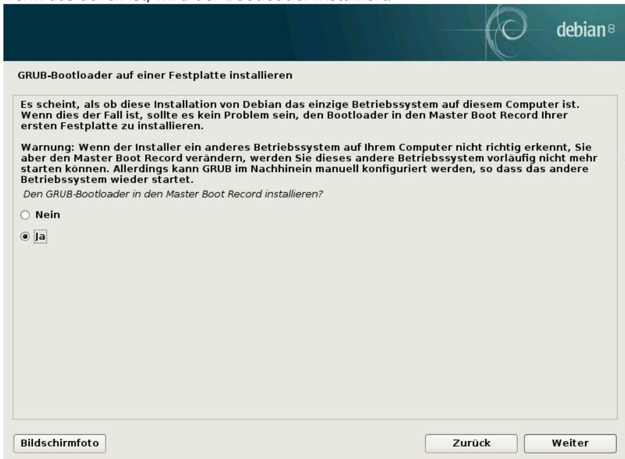
Das Gerät von dem aus gebootet wird, ist die Festplatte, die oben im Schritt der Partitionierung ausgewählt wurde.
